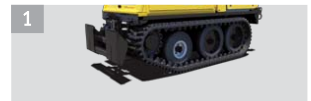
Retirez les chenilles, les barbotins et les roues.
