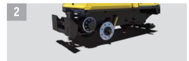
Retirez les suspensions arrière, ajustez les suspensions avant et installez les roues dentées.
