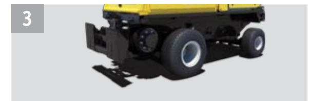
Installez les chaînes de transmission et les roues avant. Boulonnez l'ensemble de roues arrière. Branchez le système hydraulique et démarrez la fonction d'auto-calibrage.
